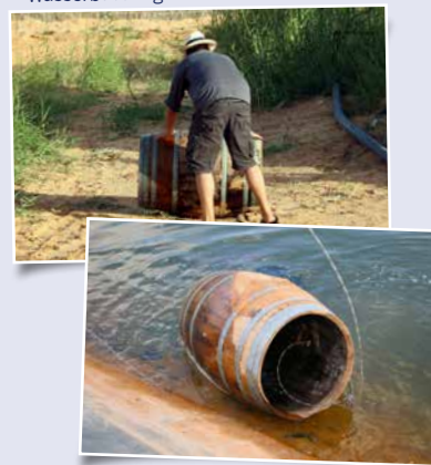
Das trockene Holz wird durch ein Bad geweitet, um das Fass abzudichten.
