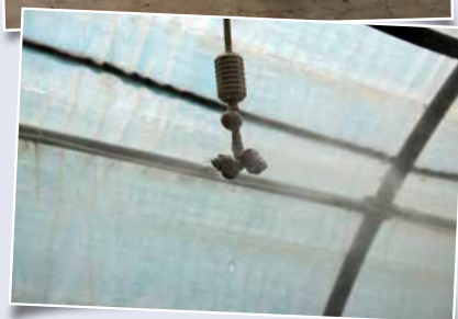
Die richtige Düse zu finden, die das Wasser fein genug für die optimale Bewässerung der kleinen Pflanzen zerstreut, war keine leichte Aufgabe.
