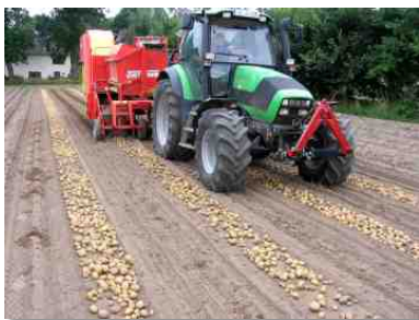
Der Sammelroder beim Aufnehmen der sauberen und trockenen Kartoffeln
